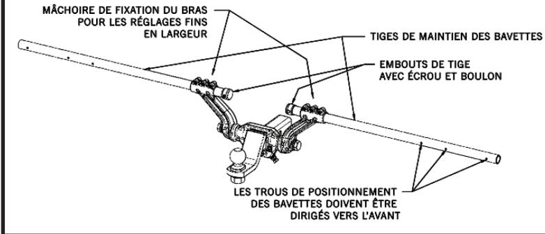
7. Faire glisser les SERRE-PATTES sur les TIGES DE MAINTIEN DES BAVETTES de sorte que les trous carrés soient dirigés à l'opposé du véhicule. Ne pas sécuriser avec les BOULONS DE RETENUE DES BAVETTES à ce stade. (Consulter le Schéma 6 pour l'orientation du trou de boulon de retenue des bavettes et les trous de positionnement des tiges de support des bavettes).
