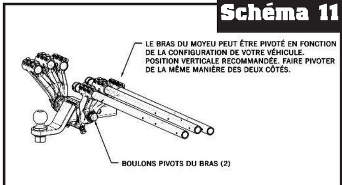
16. Finaliser l'ensemble des positionnements et réglages. Pour l'ensemble des conversions, se référer au tableau des conversions de couple de la page 1.
