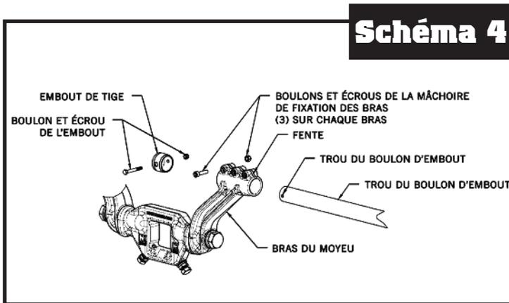
5. Réinstaller les BOULONS DE LA MÂCHOIRE DE FIXATION DES BRAS M6 et LES ÉCROUS HEXAGONAUX D'INSERTION EN NYLON M6 dans les bras du moyeu après avoir inséré la TIGE DE MAINTIEN. (*Ne pas visser à ce stade.*)
