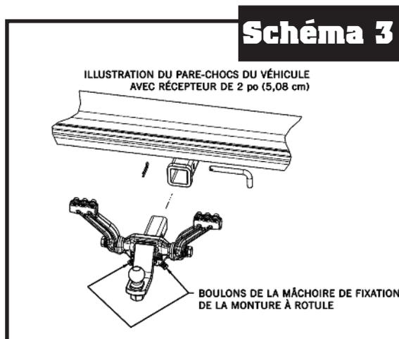
4. Desserrer ou retirer l'ensemble des trois BOULONS DE LA MÂCHOIRE DE FIXATION DES BRAS M6 de chaque BRAS DU MOYEU.
